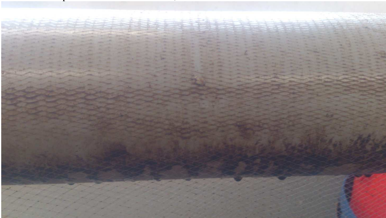
Liite 9. Verkko puomilla havas solmuväli 12,5 mm
