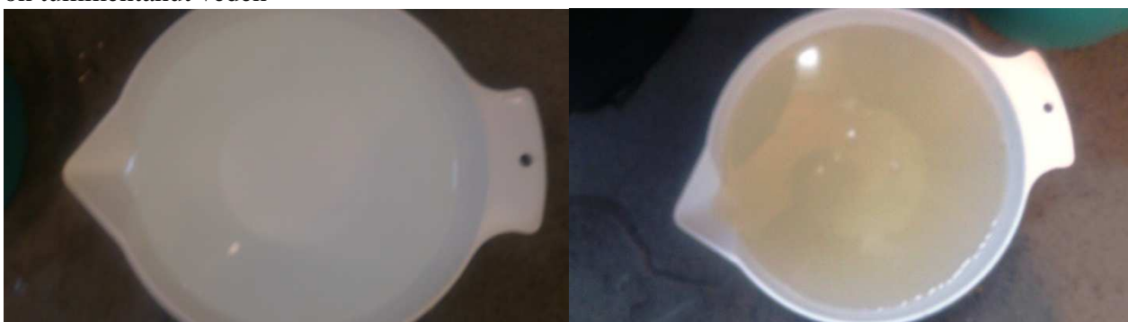
Liite 14. Pesuvesi 12 h laskeutuksen ja kiinteän humuksen erottelun jälkeen. Veteen liuennut humus on tummentanut veden
